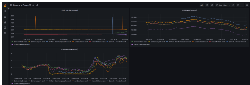
Abb. 1: Die von den eigenen Sensoren gemessenen Zeitreihen werden über den FROST-Server abgefragt und im Grafana Dashboard visualisiert
