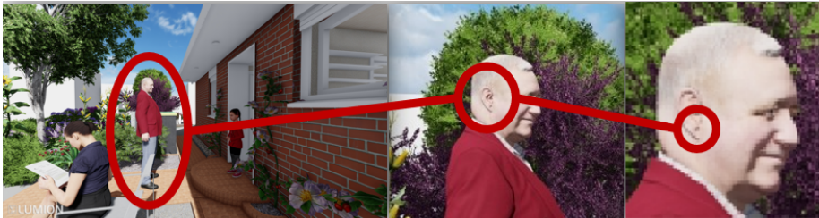
Abb. 6: Ergebnis einer Sichtfeld- bzw. Sonnenstandanalyse, fokussiert auf den durch das Kind (Zeugin) wahrgenommenen Gegenstand (Ohrstecker) [Umsetzung: Lumion – fotobasierte 3D-Visualisierung; Basis: BIM-Modell – EliteCAD (BIM-Level 3)]
