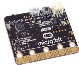
Der BBC micro:bit – Mikrocomputer aus Großbritannien, Quelle:www.experiMINT.de
