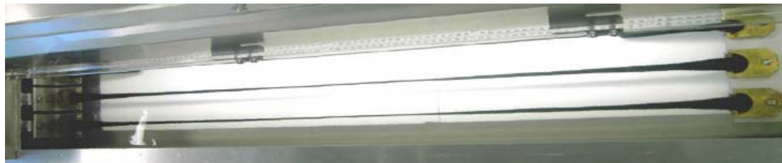
Bild 1: Prüfung der Duktilität: o. l.: Prüfkörper in befüllten Formen, o. r.: Prüfbeginn, u.: Prüfkörper kurz nach/vor dem Fadenriss bei ca. 87 cm
