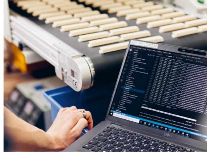
↳ Unzählige und überwiegend unstrukturierte Daten kommen täglich in der IIoT-Abteilung zusammen. Stets ermittelt werden dabei Informationen über Strom, Druckluft und Temperatur einer jeden Maschine, so auch bei dieser Anlage, die aus Aluminium Gehäuse für Industriestecker herstellt
