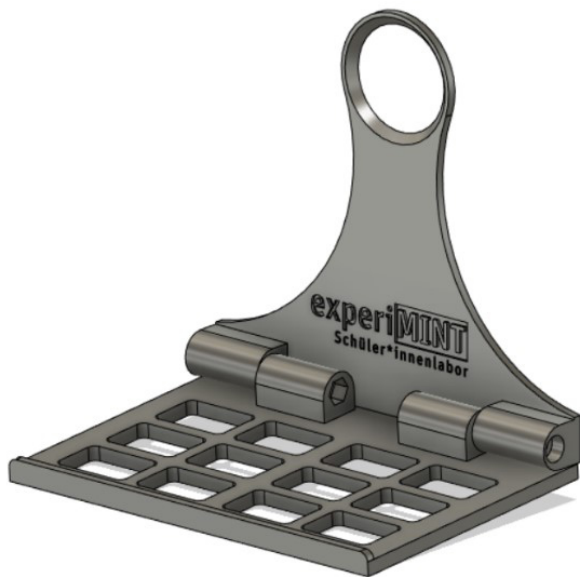
3D-Modell der zweiteiligen Handyhalterung, die eigens für das experiMINT Schüler*innenlabor von studentischen Hilfskräften konstruiert wurde (Foto: experiMINT Schüler*innenlabor)
