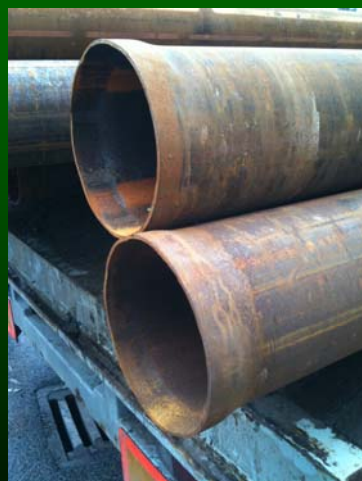
Muffe, Verbindung der einzelnen Rohrschüsse
