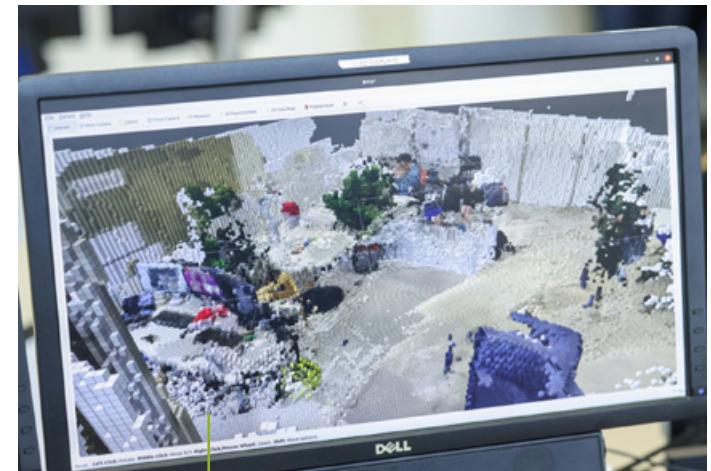
Am Computer erstellte Umgebungskarten helfen Robotern bei der Orientierung im dreidimensionalen Raum.
